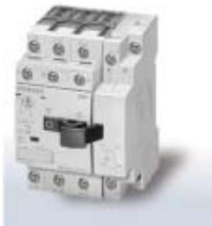
Силовые автоматические выключатели 3RV1 представляют собой компактные, токоограничивающие силовые автоматические выключатели, оптимизированные для для фидерных сборок. Выключатели применяются для коммутации и защиты трехфазных двигателей мощностью до 45 кВт при AC 400 В и, соответственно, для потребителей с расчетными токами до 100 А.
