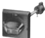
Дверные поворотные приводы состоят из рукоятки, соединительного захвата, удлинительного вала (5 x 5 мм) длиной 330 мм. Дверные поворотные приводы рассчитаны на степень защиты IP 65. Блокировка двери предотвращает непреднамеренное открывание двери электрошкафа во включенном состоянии выключателя. В отключенном состоянии запирается 3 висячими замками.
