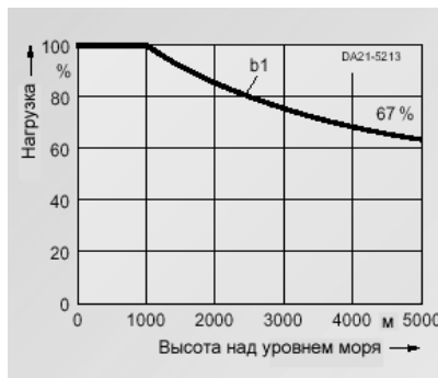
Кривая b1: коэффициент понижения нагрузки (по постоянному току) при высоте над уровнем моря
