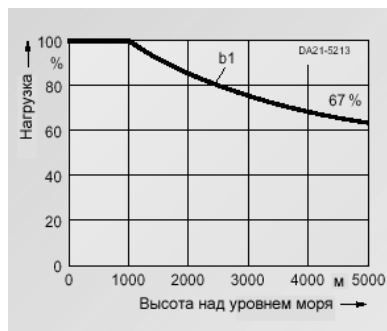
Кривая b1: коэффициент понижения нагрузки (по постоянному току) при высоте над уровнем моря более 1000 м.
