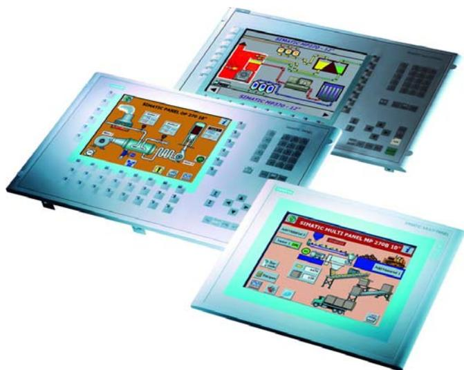
Все панели оснащены цветными графическими дисплеями с разрешением 256 цветов и широким набором коммуникационных интерфейсов: PPI/ MPI/ PROFIBUS DP (до 12 Мбит/с)/ RS 232/ RS 422/ RS 485/ USB / Industrial Ethernet, 10/100 Мбит/с.
