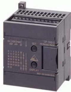
Коммуникационный процессор CP 243-2 устанавливается в программируемые контроллеры SIMATIC S7-200 с центральными процессорами CPU 22х (исключая CPU 221). CP 243-2 (6GK7243-2AX01-0XA0) поддерживает расширенный набор функций ведущего устройства AS-Interface спецификации V2.1:
