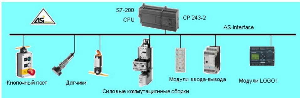
Коммуникационный процессор CP 243-2 способен работать в составе программируемых контроллеров SIMATIC S7-200 с CPU 22х (исключая CPU 221) и выполнять функции ведущего устройства AS-Interface спецификации V2.1. В один программируемый контроллер может устанавливаться до двух коммуникационных процессоров CP 243-2.
