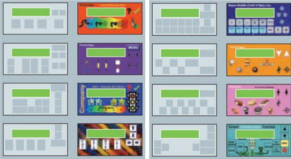
Проектирование клавиатуры и оформление фронтальной панели текстового дисплея TD 100C/ TD 200C выполняется с помощью инструментальных средств STEP 7 Micro/WIN V4.0 “TD Keypad Designer”. С его помощью выполняется:
