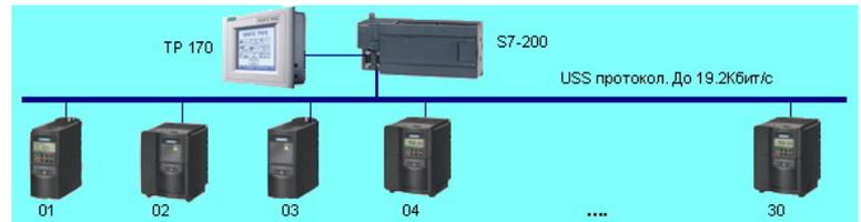
К одному контроллеру допускается подключать до 30 преобразователей частоты. Скорость передачи данных не превышает 19.2 Кбит/с.
