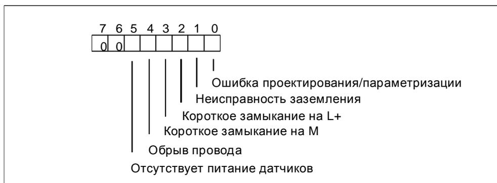
Рис. В-4. Диагностический байт для канала цифрового ввода SM 321; DI 16 x 24 VDC
