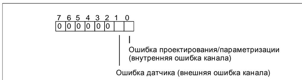
Рис. В-10. Диагностический байт для канала SM 338; POS-INPUT
