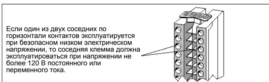
Рис. 3–35 Особенности работы с безопасным низким электрическим напряжением
