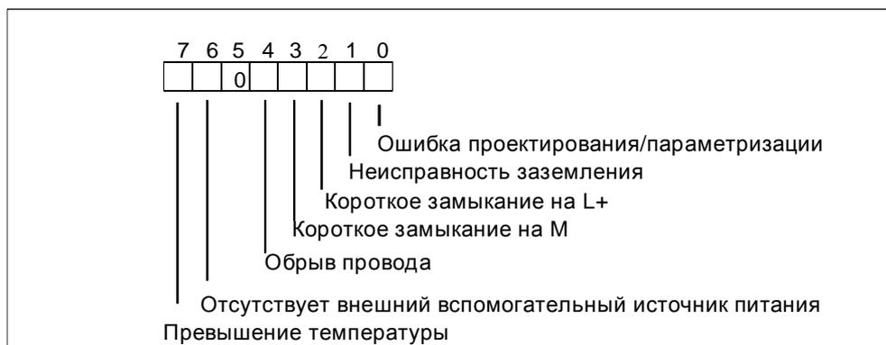
Рис. В-5. Диагностический байт для канала цифрового вывода SM 322; DO 8 x 24 VDC/0.5 A
