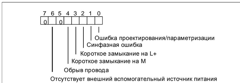
Рис. В-7. Диагностический байт канала аналогового вывода SM 332, обладающего диагностическими свойствами
