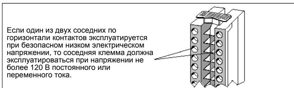
Рис. 3-33. Особенности работы с безопасным низким электрическим напряжением
