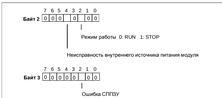
Рис. В–11. Байты 2 и 3 диагностических данных SM 422; DO 32 x 24 VDC/0.5 A
