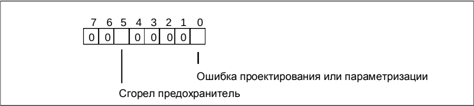
Рис. В–16. Диагностический байт для канала SM 422; DO 16 x 20–120 VAC/2 A
