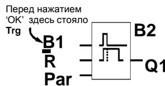
Блок B1, ранее соединенный с Q1, автоматически соединяется с самым верхним входом нового блока. Обратите внимание, что соединять можно только цифровые входы с цифровыми выходами, а аналоговые входы с аналоговыми выходами. В противном случае 'старый' блок теряется.
