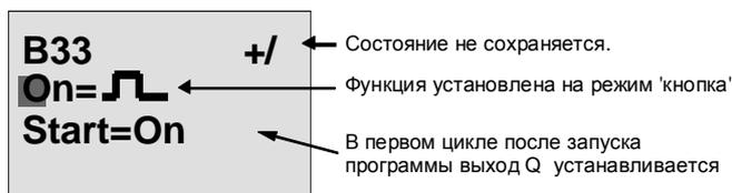
Изменение параметра 'Par' на 'Switch [Выключатель]' и изменение состояния в первом цикле после запуска программы производятся следующим образом:
