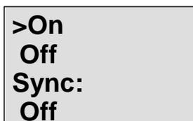
Текущая настройка функции автоматической синхронизации отображается в нижнем ряду. Установка по умолчанию 'Off': деактивизирована.
