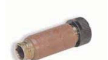
Применяется в малых моторах, простая замена ще ток, конструкция из латунного профиля или листа, изоляция из жесткой бумаги или опрессовка пластиком, штепсельный ввод, припаянный желобок или винтовое соединение
